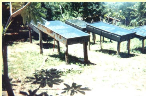
Figura 1 Secador Solar
