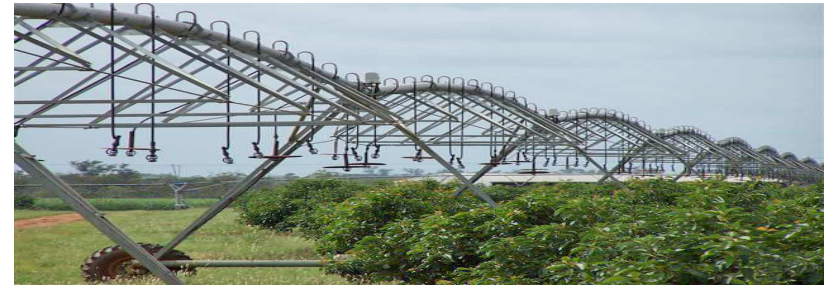
Figura 3: Sistema de irrigação por pivô central Fonte: Valley (2010)
