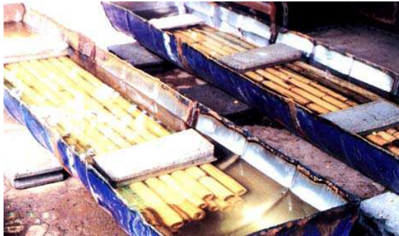
Figura 27: Tratamento das varas pelo método de imersão em produtos químicos.
